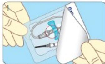
**Attention**, à l'ouverture de l'emballage, saisir le dispositif par son embase pour ne pas risquer l'activation du mécanisme de rétraction de l'aiguille, en appuyant involontairement sur le bouton avec le triangle noir.
